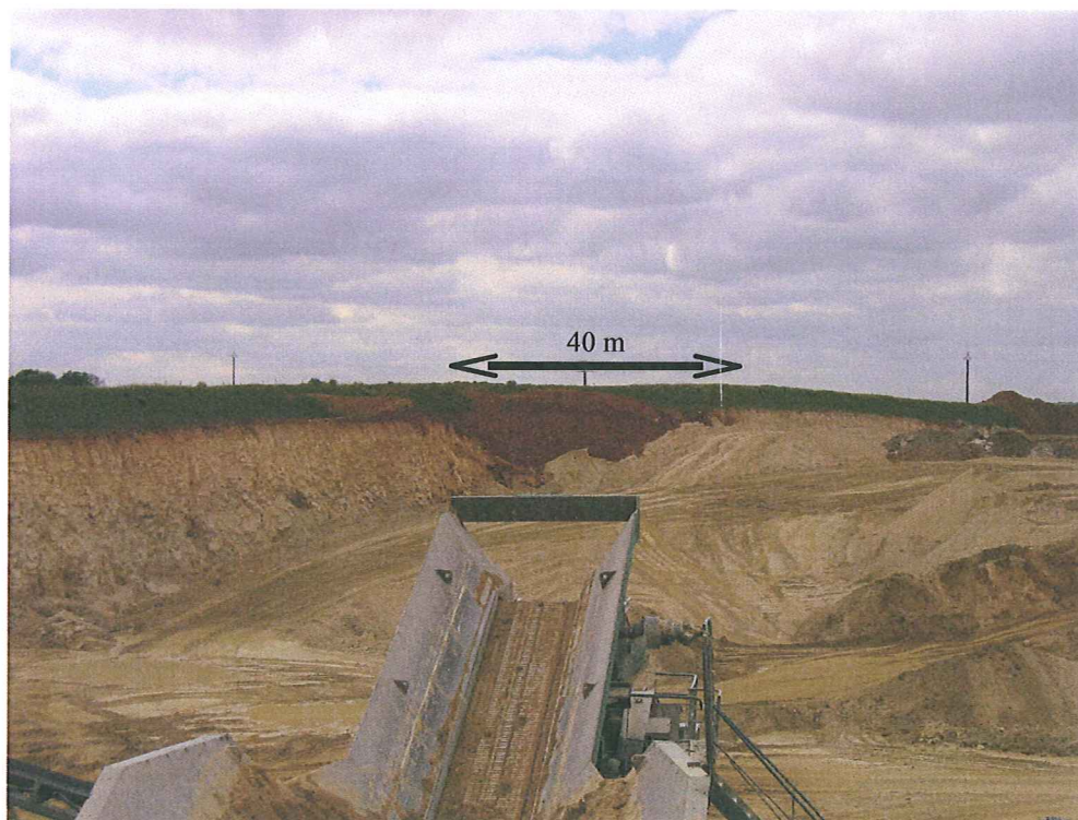
Figure 5 : Vue du front de taille Sud-Ouest et de la poche argileuse depuis le haut du concasseur primaire (photo prise le 06/02/2009)
